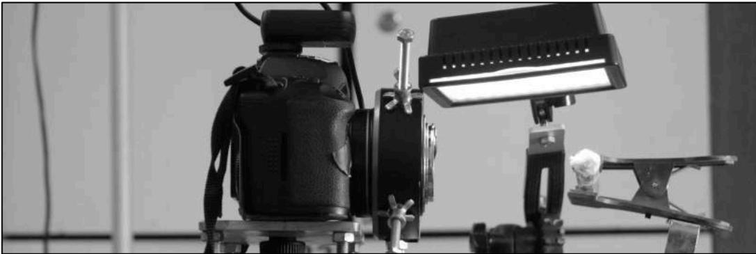
L'objectif est monté à l'envers grâce à un système de bagues que j'ai confectionné spécialement. L'optique est maintenue par des vis qui le solidarisent aux rails 15mm.
