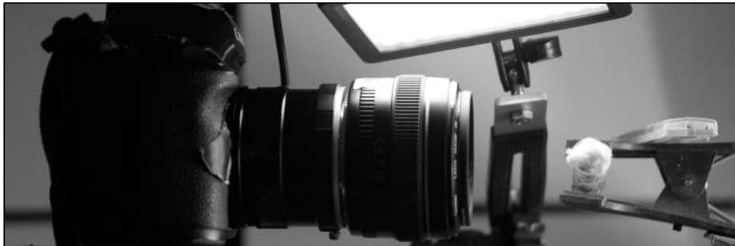
L'objectif est monté à l'endroit et le tirage est augmenté grâce à un jeu de bagues allonge de 5cm. Le tirage interne à l'objectif réglé sur l'infini étant de 5cm également (50mm) il s'agit bien d'une configuration double tirage.
