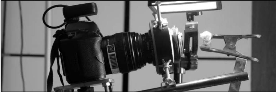
L'objectif 100mm est monté à l'endroit, mise au point sur l'infini et face à lui est placé le 35mm à l'envers, lui aussi réglé sur l'infini.
