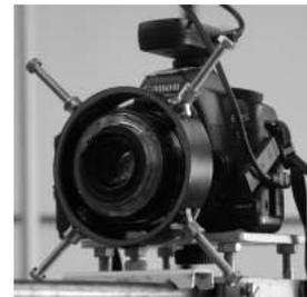
Sur ces optiques numériques qui ne possèdent pas de bagues de diaph, si on veut conserver la fermeture du diaphragme sans qu'il soit connecté au boîtier, il faut démonter l'objectif en apurant sur le bouton test du diaphragme.
