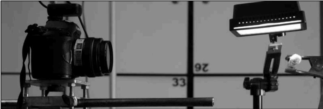
L'objectif est monté normalement et la mise au point est réglée à la distance la plus courte sur la position notée « macro » par un pictogramme.
