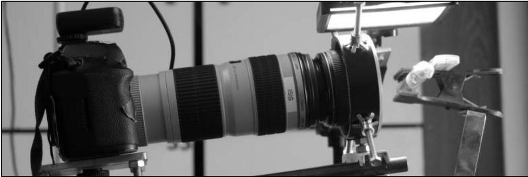
L'objectif 70-200 est monté à l'endroit sur la position 200 mm, mise au point sur l'infini. Et le 28 mm est monté à l'envers, mise au point sur l'infini également.
